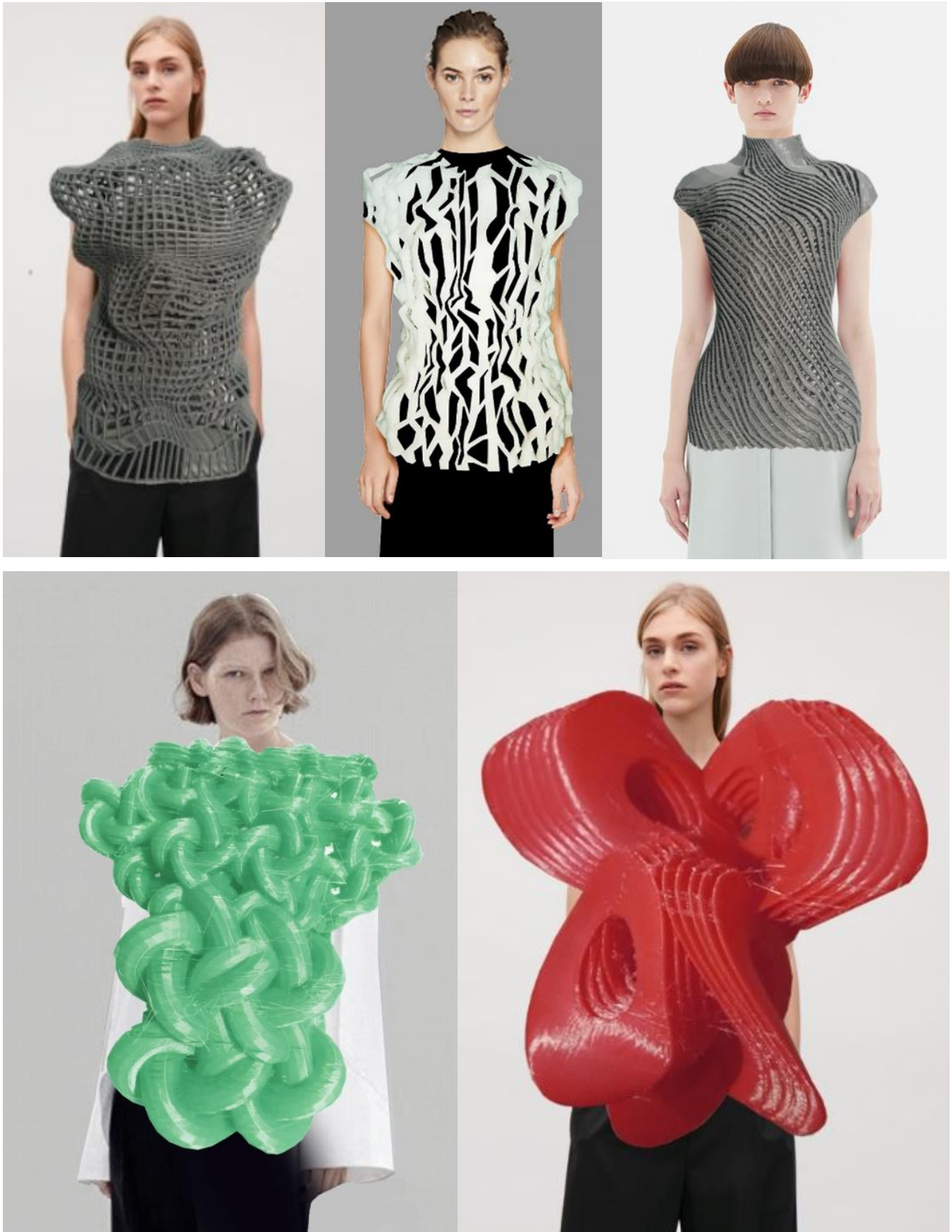
Рисунок 3 – Практическая апробация дизайн-проектирования монолитной формы одежды на основе FDM-печати. Демонстрация одежды на фигуре человека при условии печати высотой 625-650 мм.
