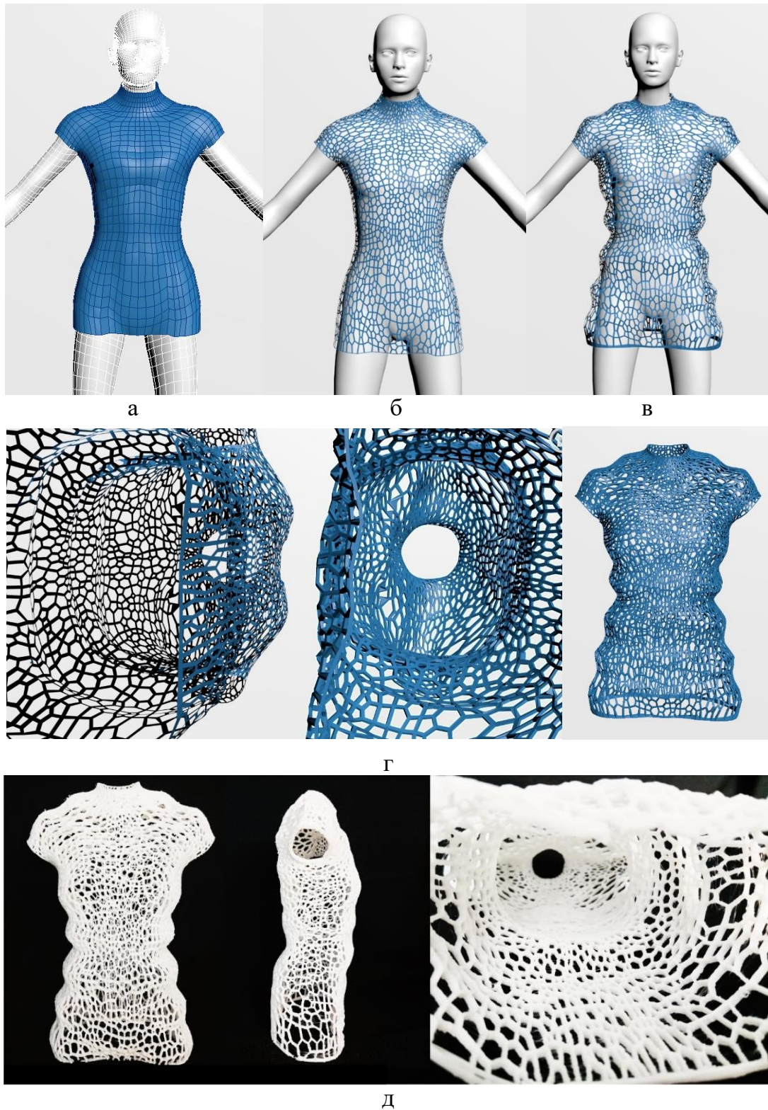
Рисунок 2 – Практическая апробация дизайн-проектирования монолитной формы одежды на основе FDM-печати : (а) оболочка-примитив с заданной геометрией сетки; (б) выполнение перфораций (Bevel); (в) модификация формы (Free Form); (г) утолщение формы (Shell); (д) напечатанная модель на 3D-принтере в масштабе 1/2,5
